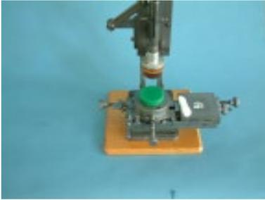
Le chariot horizontal est alors déplacé manuellement vers la droite de sorte à ce que la pièce à imprimer passe sous le tampon.
