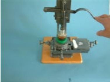
Une nouvelle course permet d'appliquer l'image d'impression sur la pièce à imprimer.
