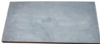
Les clichés en acier sont principalement utilisés quand une précision élevée (graduations, modélisme ferroviaire, échelles de mesure, etc.) ou de grandes quantités sont nécessaires. Le cliché en acier est composé d'un acier à outils d'environ 64 Rockwell. La surface utilisée est rectifiée et rodée pour passer à la classe de rugosité N\*.
