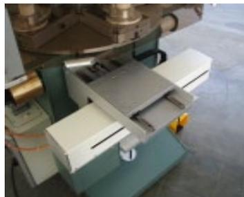
Table de déplacement entraînée par moteur linéaire avec dispositif de basculement programmable
