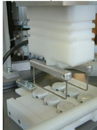
L'indication de puissance d'une électrode ne peut pas être augmentée n'importe comment. C'est la raison pour laquelle plusieurs électrodes sont utilisées en parallèle lorsque les vitesses sont élevées, par exemple deux à partir d'environ 100 mm/min. Le prétraitement Corona dégage de l'ozone. Une aspiration est impérative dans les grandes installations. Une règle de base veut que sentir de l'ozone, c'est déjà trop.
