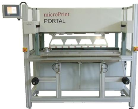
Portalmaschine zum Bedrucken von Kathetern
