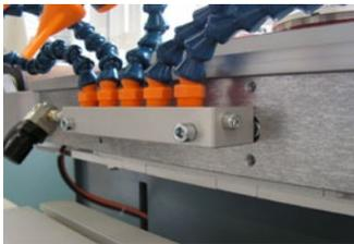
Die Tamponanblasvorrichtung kann mit Schrauben **seitlich** montiert werden.
