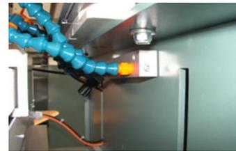
Die Tamponanblasvorrichtung kann **magnetisch** befestigt werden.
