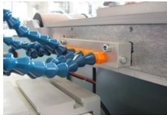
Die Tamponanblasvorrichtung kann mit Schrauben **waagrecht** montiert werden.
