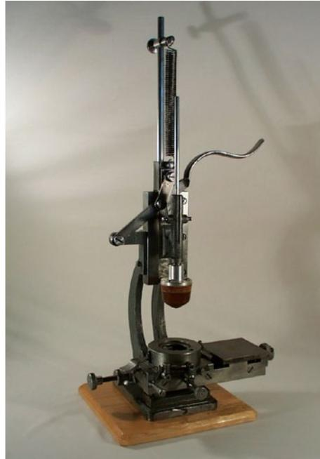
Die ersten Tampondruckmaschinen
