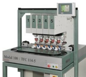
**microPrint Modul 100 110 130 200** ist die Maschinen Linie für vollautomatische Fertigung. Die Maschine besitzt optional einen Bus Anschluss worüber alle Parameter (Maschineneinstellungen plus Druckpositionen) eingegeben werden können. Diese Maschinen sind sehr schnell und können auf der Y-Achse verschiedene Bilder aufnehmen und an verschiedenen Positionen abgeben. Dabei kann das Tampon-Reinigungsband voll ausgenutzt werden.
