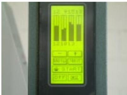
Viskositätswerte werden auf dem Touch-Screen als Balkendiagramm dargestellt. Durch Drücken der Plus- oder Minustaste kann der gewünschte Viskositätswert eingegeben werden
