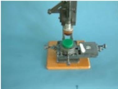
Nun wurde der horizontale Schlitten von Hand nach rechts verschoben so dass das zu bedruckende Teil unter den Tampon kam.
