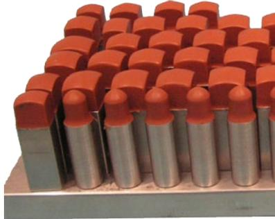
Im weiteren besteht die Möglichkeit, eine vorhandene Tamponform abzuändern (z.B. sie kürzen oder mit Hohlräumen zu versehen) und damit einen neuen Tampon zu gießen.
