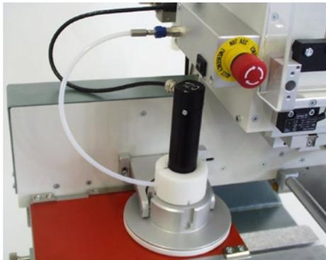
Tampondruckmaschine mit einem Viscomaten
