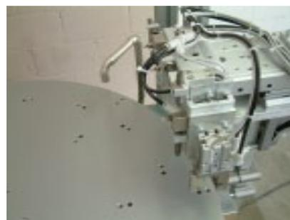
Punktuelle Zuführung verhindert das zu starke Aufwärmen der Umgebung und bringt die Wärme dahin wo sie gebraucht wird
