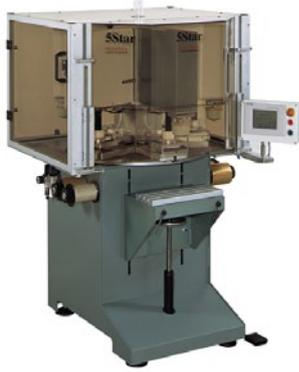
**microPrint 5 star.** Mit der Entwicklung des 5 Farben Tampondruck Zentrums 5star hat microPrint neue Massstäbe gesetzt. Mit nur einer Aufnahme können 5 Farben jede einzeln optimal programmierbar gedruckt werden.
