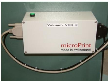
Vakuum Halte- und Druckluftausstosseinheit VEB2
