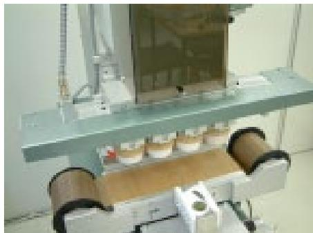
Mehrfarben Druckmaschine mit Tamponverschiebung MS 250
