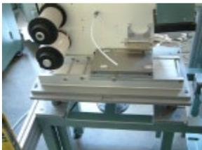
Zusatztisch für die Tampondruckmaschinen MSS 130
