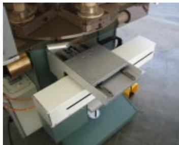
Linearmotor angetriebener Verschiebetisch mit programmierbarer Kippvorrichtung
