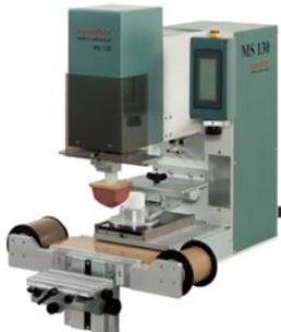
**microPrint MS** Serie ist eine konventionelle Maschinenlinie jedoch mit all den modernen Optionen wie automatische Tamponreinigung und automatischer Viskositäts und Klischeetemperaturregulierung. Der Antrieb ist pneumatisch
