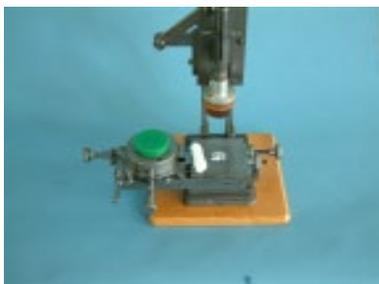
Dann wurde die Farbe mit einem Spachtel abgezogen. Auf dem Klischee blieb die Farbe in der Vertiefung, das dem Druckbild entspricht, zurück.
