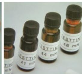
Prüfstifte für die Oberflächenspannungs-
