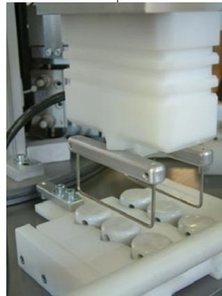
Die Leistungsangabe einer Elektrode kann nicht beliebig gesteigert werden. Deshalb werden bei höheren Geschwindigkeiten mehrere Elektroden parallel betrieben, ab etwa 100 mm/min zwei.
