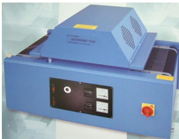
UV-Strahler mit Durchlauftransportband
