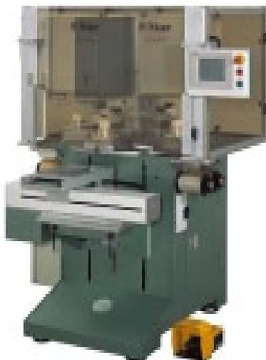
5 Farben Tampondruckmaschine 5star mit Verschiebetisch
