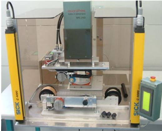
MS 250 mit präzisions Runddruckvorrichtung und Lichtschranken Sicherung
