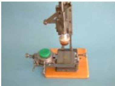
In der Druckausgangsposition befindet sich das Klischee unter dem Tampon
